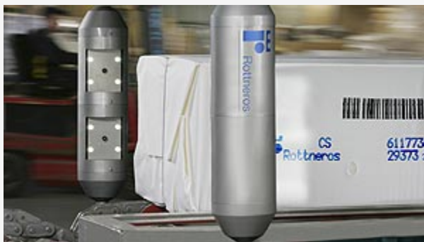
Das VMI-System des Zellstoffproduzenten Rottneros liefert dem Benutzer wichtige Rohstoffdaten, die zur Feinjustierung des Produktionsverfahrens verwendet werden können.
