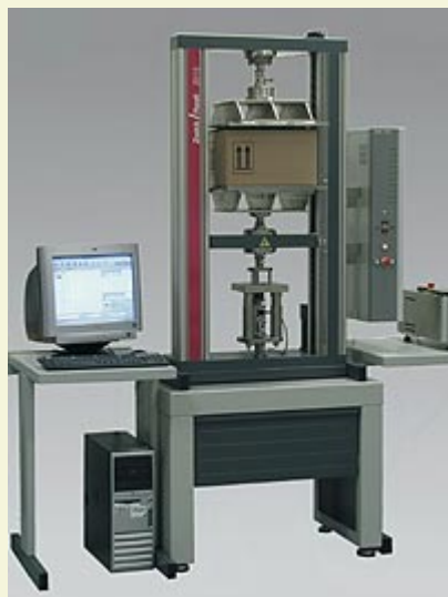
Zwick-Prüfmaschine Typ Z010 mit zwei Arbeitsräumen
