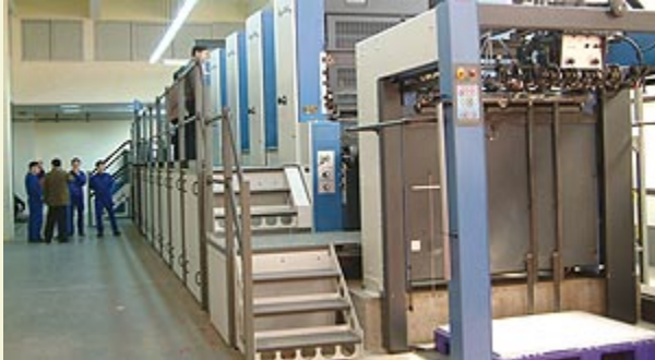
Die Fünffarben-Rapida 142 ist unter anderem mit einem Zusatzpaket für den Druck auf Starkarton und Mikrowelle ausgerüstet.
